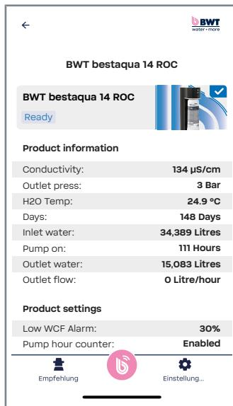
**DE:** Folgende Betriebsdaten erscheinen im Bereich „Product Information“: Leitfähigkeit [TDS or  $\mu\text{S}/\text{cm}$ ], Ausgangsdruck [bar], Wassertemperatur [ $^{\circ}\text{C}$ ], Laufzeit seit Inbetriebnahme [days], Wasserzähler Eingang [l], Betriebsstunden Pumpe [h], Wasserzähler Ausgang [l], Produktionsmenge [l/h]
