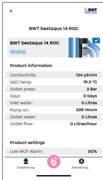
**DE:** Nach jeder Produktion wird die Membran für 10 s mit Eingangswasser gespült. Wenn keine Produktion stattfindet, wird die Anlage alle 3 Stunden mit Eingangswasser gespült.
