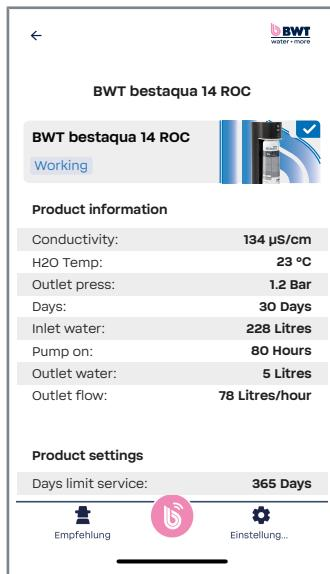
**DE:** Während des Bezugs zeigt die APP den Status „working“ an. Die Umkehrosmose ist in Produktion.
